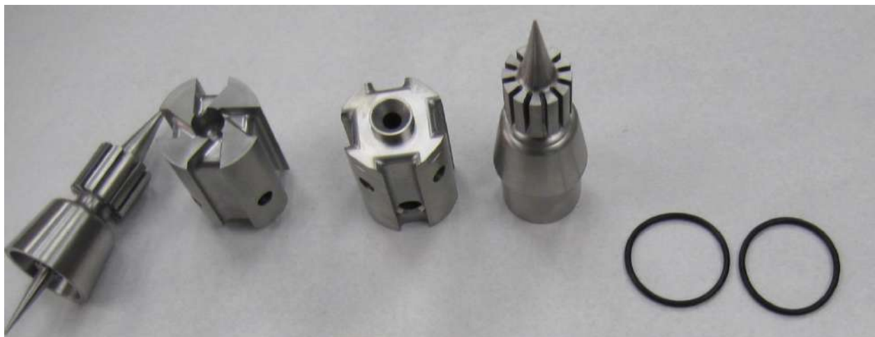
Рисунок 5. Элементы устройства динамического смешивания и гомогенизации
