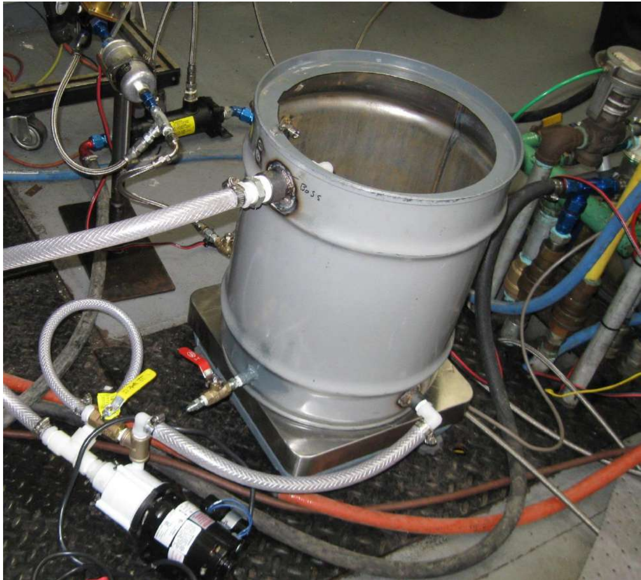
Рисунок 14. Система повторного смешивания объемом 10 галлонов, подключенная к испытательной установке в лаборатории Roush, в процессе сгорания; Дизельный двигатель 2,4 л
