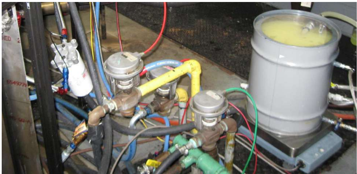
Рисунок 15. Система повторного смешивания объемом 10 галлонов, подключенная к испытательной установке в лаборатории Roush, в процессе сгорания; Дизельный двигатель 2,4 л
