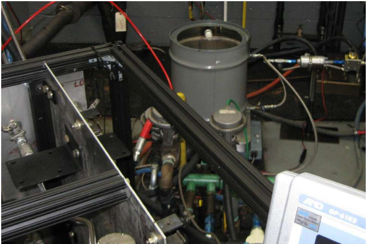
Рисунок 13. Система повторного смешивания объемом 10 галлонов, подключенная к испытательной установке в лаборатории Roush, в процессе сгорания; Дизельный двигатель 2,4 л
